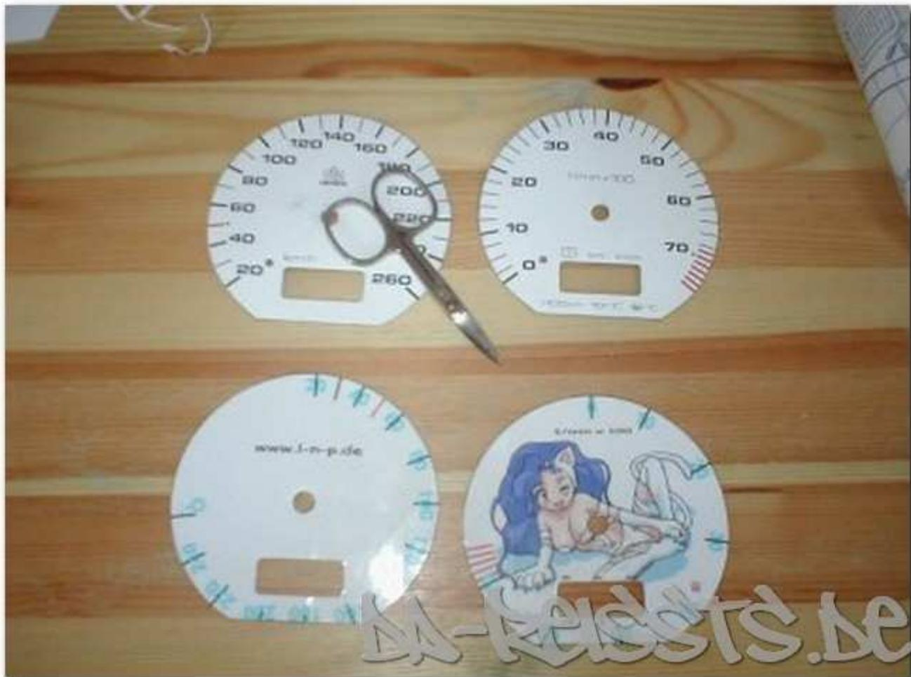
Beim Drehzahlmesser sowie dem Tacho müssen die "Nullstellungsnadeln" versetzt werden. Dafür erstmal vorsichtig die Anzeige-Nadel runterziehen, und dann mittels einer Kombizange den Null-Stift rausziehen (rauswackeln). Nun die dazugehörige Folie drauf, und mittels eines 2mm Bohrers ein neues Loch für den Null-Stift bohren (siehe Bild unten)
